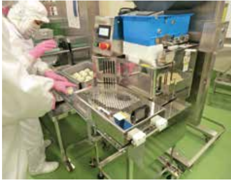
1時間3,000個の製造能力を持つ「おにぎり製造機」
